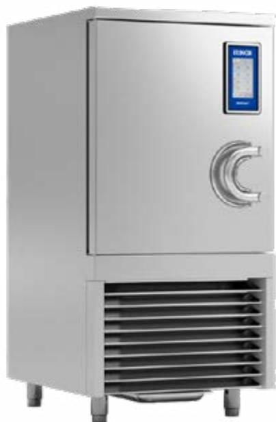
Irinox MultiFresh MF 45.1 abbattitore multifunzione 10 teglie con resa di 45 kg in raffreddamento e in surgelazione. Multifunzione: abbatte, surgela, cuoce a bassa temperatura, lievita, mantiene al caldo, pastorizza. Range di temperatura gestita da -40° a +85°.
